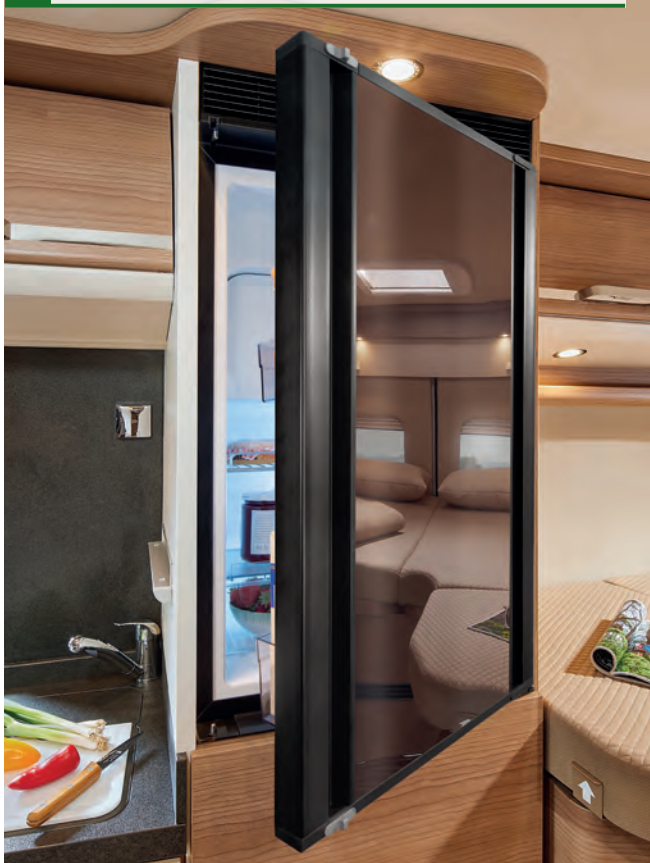
2 Frigorifero a compressore da 70 l posizionato a comoda altezza
