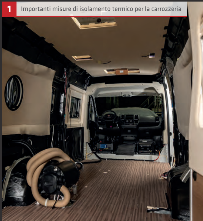
2 Pareti laterali e montanti della carrozzeria rivestiti senza ponti termici
